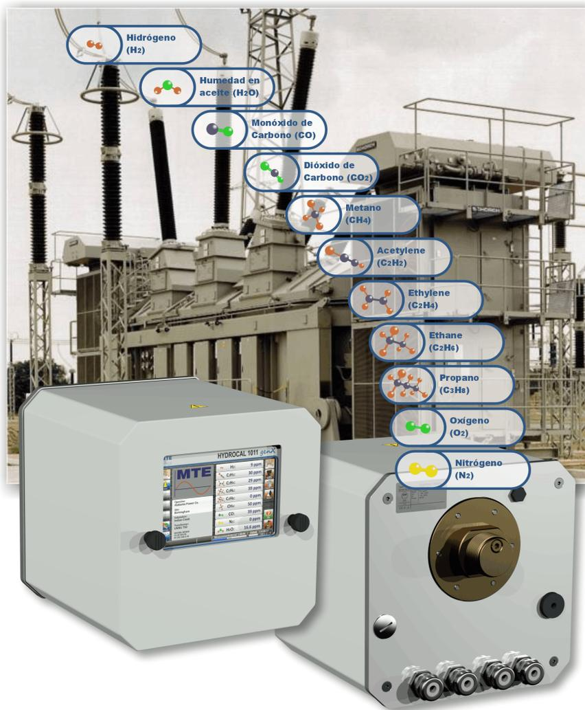
El nuevo HYDROCAL 1011 *genX* es una solución DGA multigás online libre de mantenimiento de rango completo que combina la tecnología ya probada de medición de infrarroja (NIR) con la producción de muestras de gas miniaturizadas basada en el principio de espacio de cabeza (sin membrana, a prueba de presión negativa).
